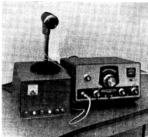
Voor aanzicht van de Heathkit HW32A met daarbij een zelfgemaakt voedingsapparaat voor deze zendontvanger. Op de HW32A van links naar rechts: final tune, afstemming, S-meter met meterschakelaar. Daaronder eveneens van links naar rechts: de microfooningang, h.f.- en l.f.-regeling, USB/LSB schakelaar, microfoonversterker en functieschakelaar: off-p.t.t.-vox-cal.
